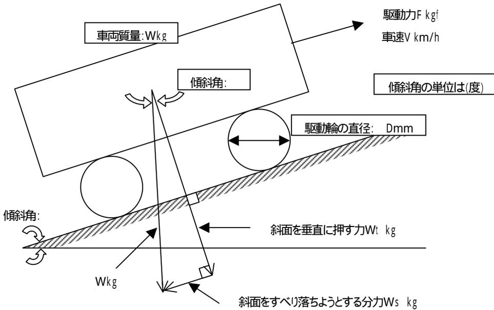
台車が斜面を登るときは車両の質量を斜面を垂直に押す力 $W_t$ と斜面を滑り落ちようとする分力 $W_s$ に分けて考えればよい。
